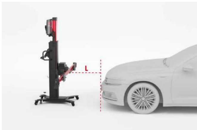
Rysunek 6-136 Wyśrodkuj ramkę kalibracji
