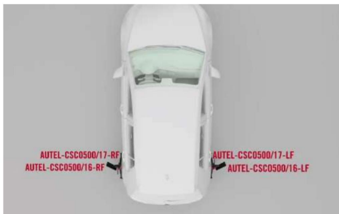
Rysunek 6-31 Montaż zacisków kół (zacisków opon) i tarcz
