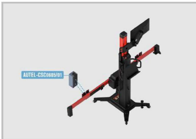
Rysunek 6-34 Montaż skrzynki kalibracji radaru na lewej płycie przesuwnej
