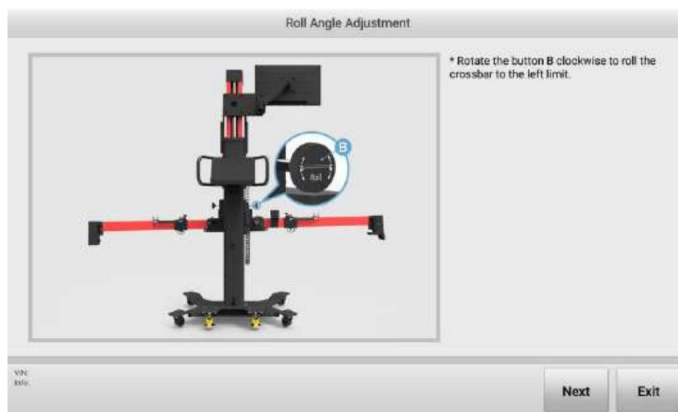
Rysunek 5-57 Regulacja kąta przechyłu 1
