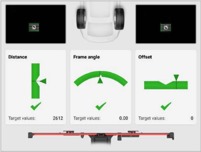
Rysunek 6-32 Dostosowanie ramki kalibracyjnej
