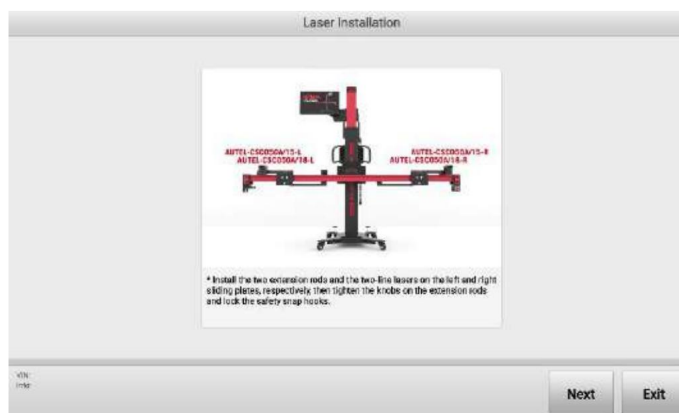
Rysunek 5-64 Instalacja laserów dwuliniowych
