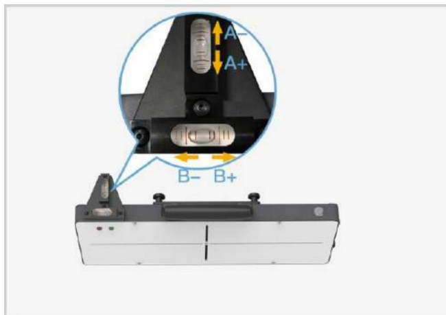
Rysunek 6-116 Wyśrodkuj bąbelek na poziomicy
