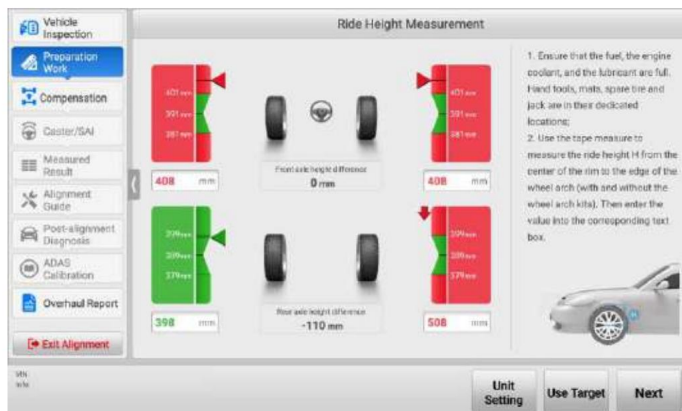
Rysunek 4-30 Pomiar wysokości jazdy za pomocą taśmy 1
