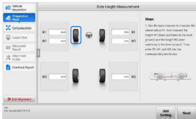
Rysunek 4-31 Pomiar wysokości jazdy za pomocą taśmy 2
