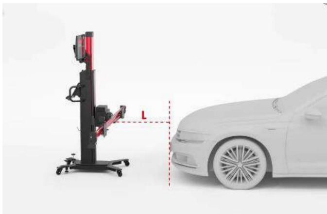
Rysunek 6-95 Wyśrodkuj ramkę kalibracji
