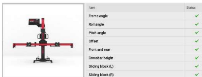
Rysunek 6-94 Automatyczne pozycjonowanie poprzeczki
