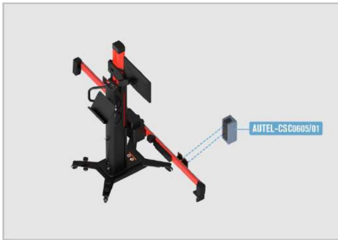
Rysunek 6-37 Montaż skrzynki kalibracji radaru na prawej płycie przesuwnej
